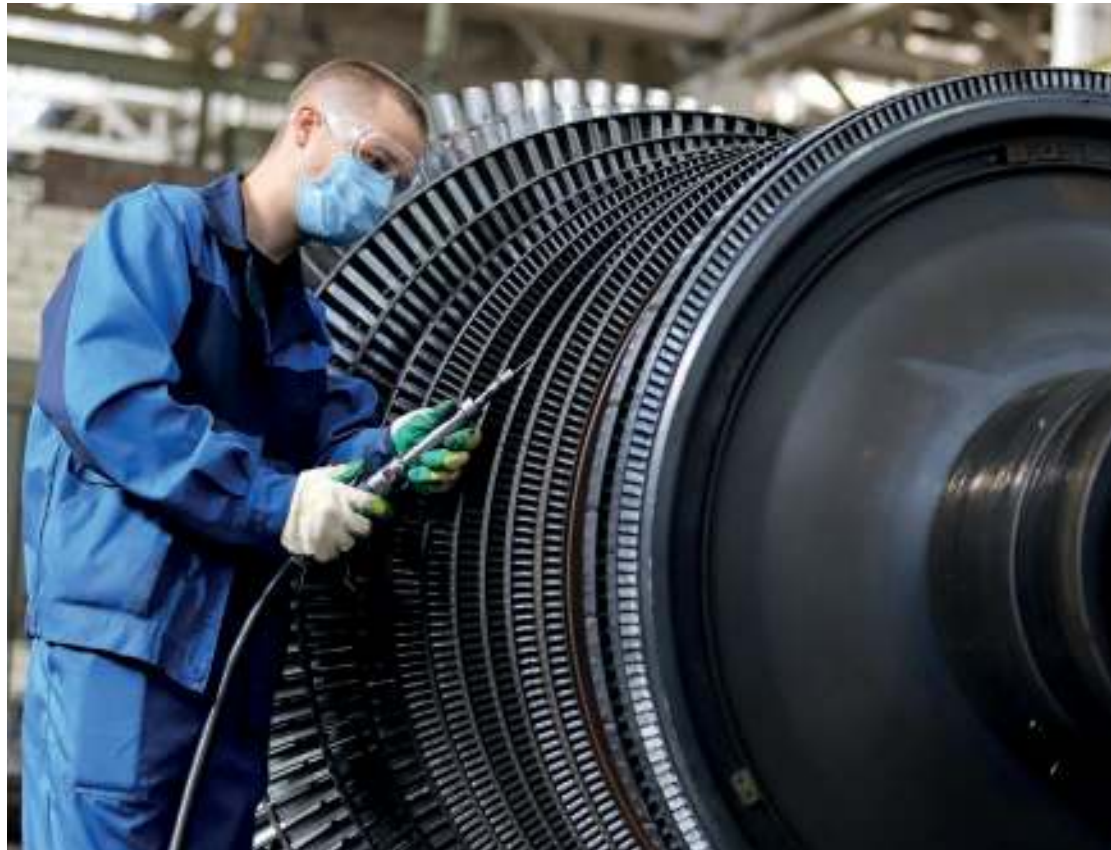
В роторе турбины воздушного компрессора больше 3000 металлических лопаток. И каждую отчистят до блеска
